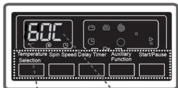
يمكنك اختيار درجة حرارة ماء الغسيل بزر ضبط درجة حرارة ماء الغسيل.
