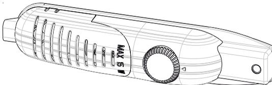
Le thermostat régule la température du compartiment réfrigérateur, ainsi que celle du compartiment congélateur. En tournant le bouton de la position 1. vers la position 5., vous pouvez obtenir des températures de plus en plus froides.
