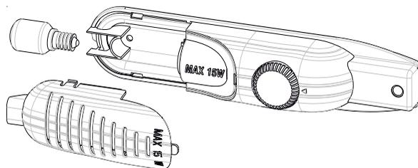
Pour remplacer l'ampoule du compartiment réfrigérateur :
